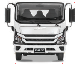
Ancho entre llantas delanteras 1.570 mm
